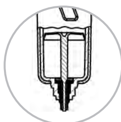
Depressurisation drain Type 4
